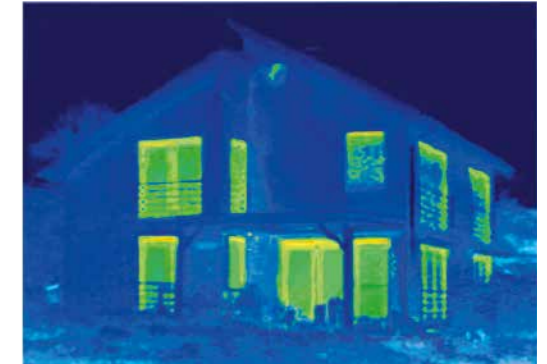
Na de zorgvuldige plaatsing van nieuwe ramen van het Schüco LivIng Variant systeem bewijst de thermografie dat de energie-investering zich goed loont. Het oorspronkelijke energieverlies is nagenoeg volledig weggewerkt.
